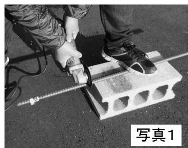
**【手順2】** 次に切り分けた鉄筋を“研磨砥石”を装着したグラインダーを斜めに当てて鉛筆のように尖らせていきます。これは“切断砥石”でもOK。（写真2）概ね先端から5cm程度の範囲をひたすら削っていきます。（写真3）余った方（30cm）ももったいないんで、こちらも削ります。ひたすら削ります…。夜やるとわかるんですが、鉄筋は摩擦で真っ赤になる程熱くなりますんで気をつけて。で、研ぎあがったら、冷水にジュッ！…焼き入れをします。この作業約5分×2。できあがったものがコレ。（写真4）
